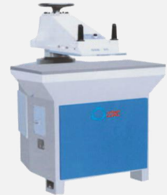
스윙빔 재단기 Swing Beam Cutting Machine
